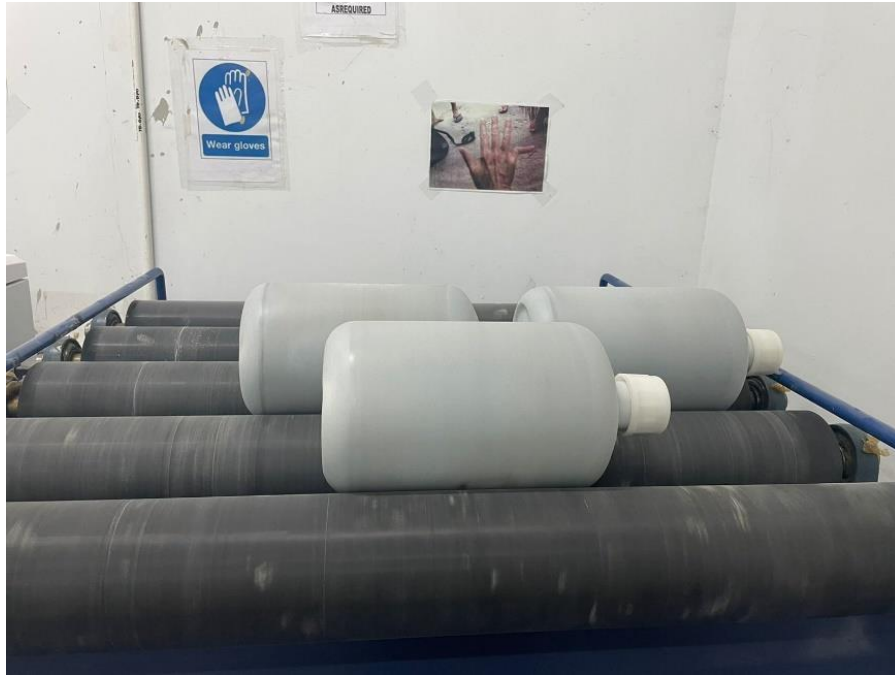
Gambar D. 7 Percobaan Pelindian Menggunakan Bottle Roller
