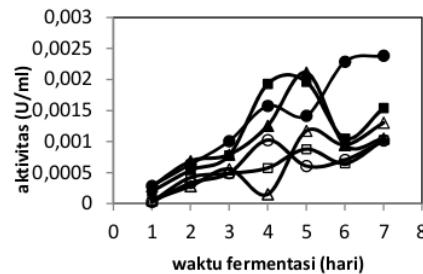
Gambar 3. Pengaruh kadar air substrat pada aktivitas enzim selulase, dengan substrat jerami padi; ● CMC-ase (60%); ■ CMC-ase (70%); ▲ CMC-ase (80%); ○ FP-ase (60%); □ FP-ase (70%); Δ FP-ase (80%)
