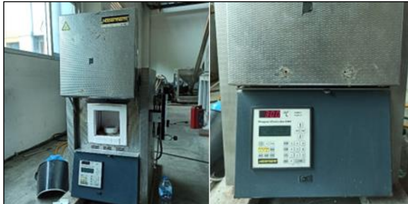
Gambar 4.3 Proses Kalsinasi Material Aktif Katoda dengan Muffle Furnace
