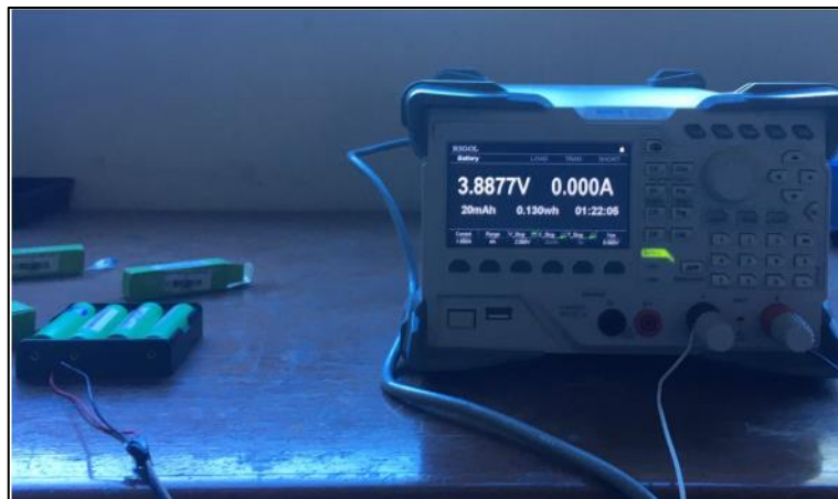
Gambar 4.1 Proses Pengosongan Muatan LIB Bekas dengan RIGOL DL 3021
