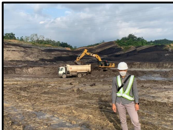
Gambar 2.9 Pengupasan dan Pemuatan Overburden
