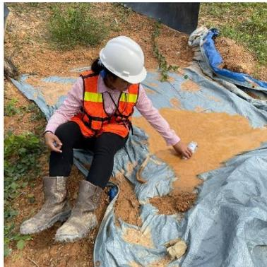
**Gambar 3.13. Pengambilan Sampel ke Dalam Botol Berukuran 600 ml LP 17**
