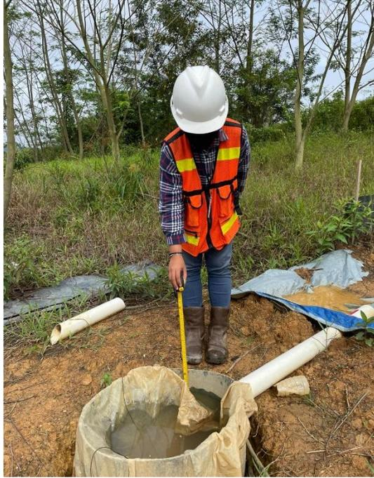
**Gambar 3.15. Mengukur Ketinggian Air Menggunakan Meteran LP 23**
