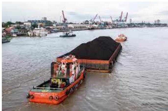
**Gambar 2.10. Proses Pengangkutan Batubara Menggunakan Tongkang**
