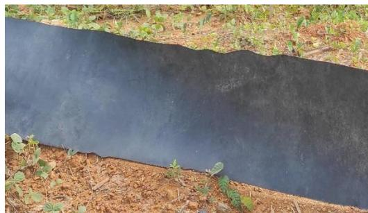
**Gambar 3.9. Geomembran untuk Dinding Petak Erosi**
