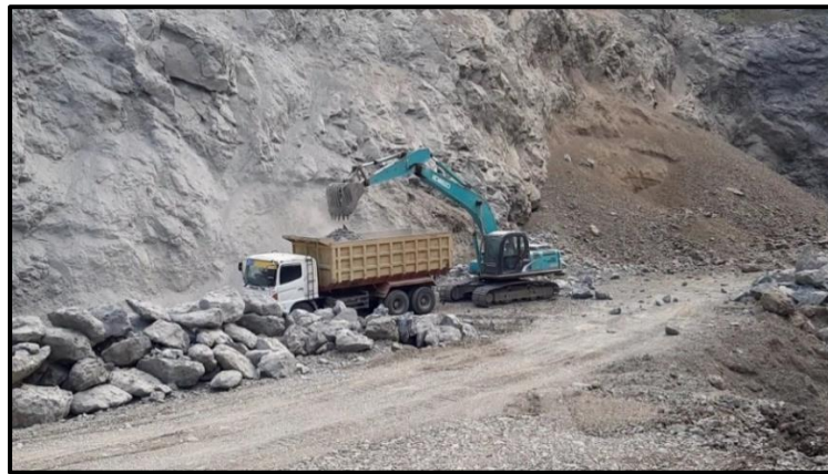
Gambar 4.1 Kegiatan Pemuatan dengan Excavator Kobelco SK 200
