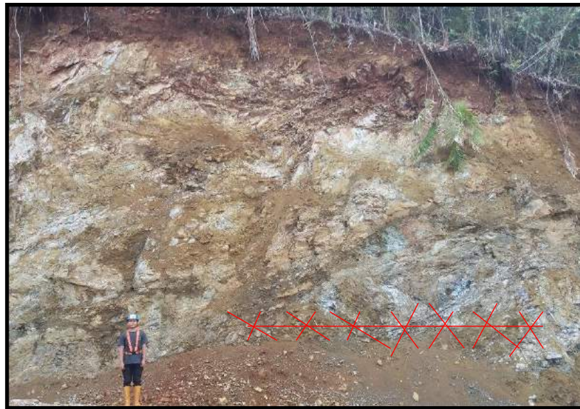
Gambar VI.10 Foto Singkapan Lereng 03 dan Pengukuran Bidang Diskontinuitas Menggunakan Metode Scanline (Azimuth Foto : N 332^{\circ} E )
