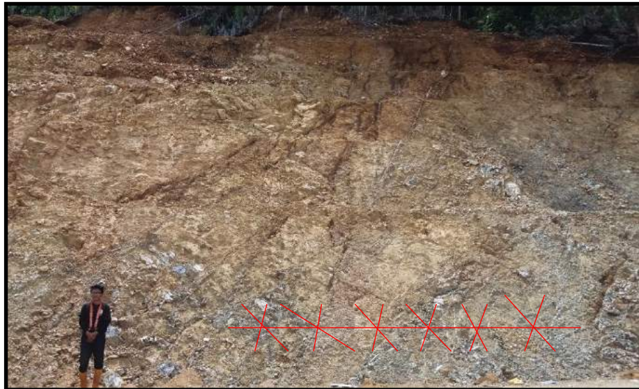
Gambar VI.13 Foto Singkapan Lereng 04 dan Pengukuran Bidang Diskontinuitas Menggunakan Metode Scanline (Azimuth Foto : N 314 0 E)
