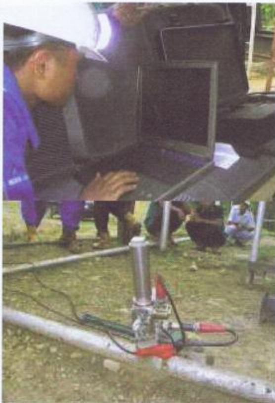
Gambar 2.34. Uji produksi dan tekanan pada sumur tua dengan Echometer
