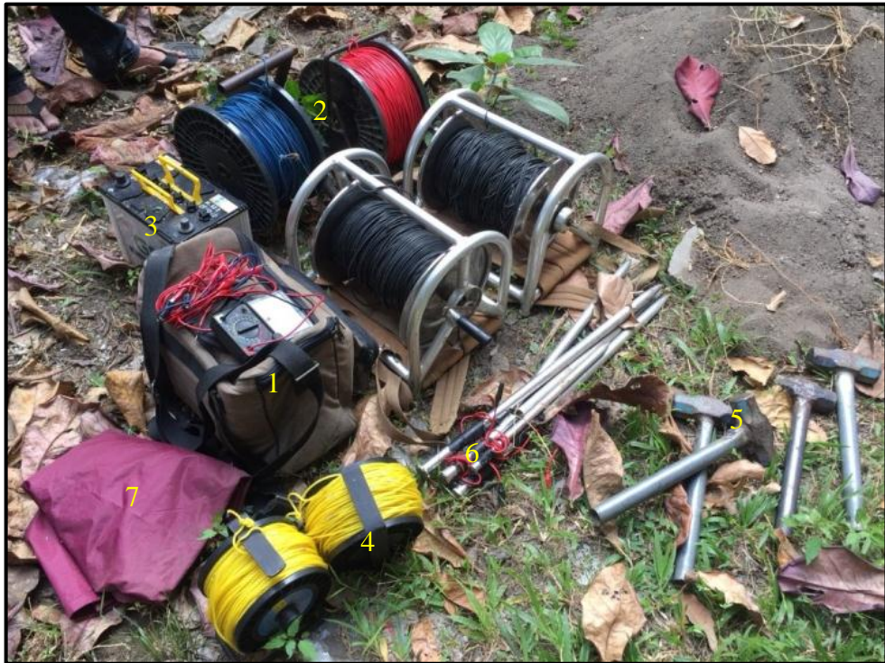
Gambar 4.3 Peralatan dan perlengkapan akusisi data geolistrik
