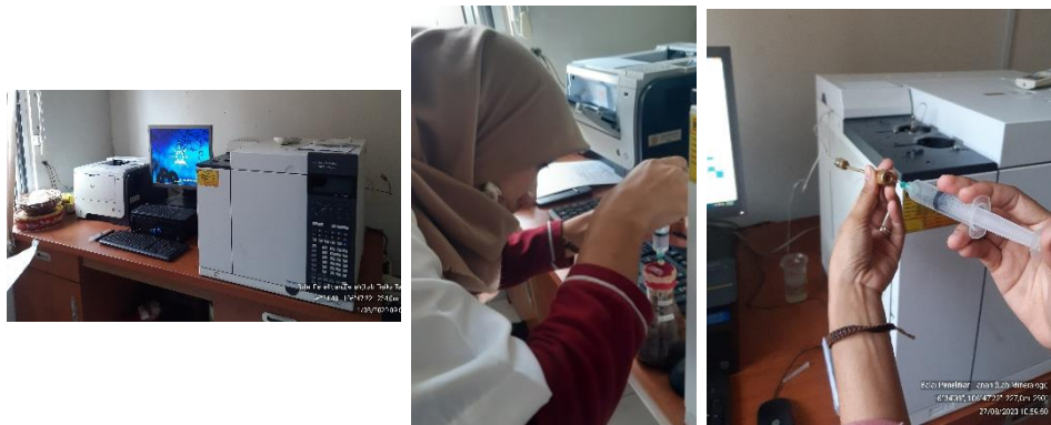
Gambar 3.6 Seperangkat alat gas kromatografi (kiri), dan proses pengambilan dan penginjeksian gas CO 2 (tengah,kanan)
