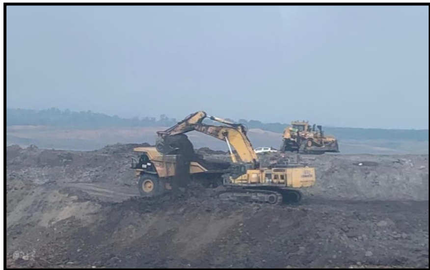
Gambar 2.9 Kegiatan Pemuatan tanah penutup
