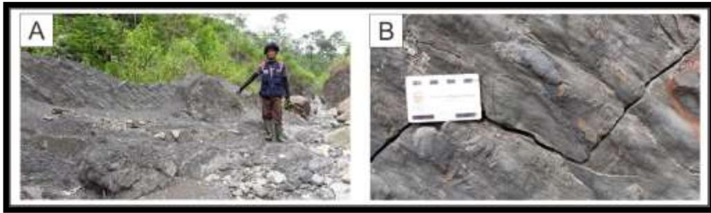
Gambar 5.30. Foto parameter singkapan batulempung napalan dengan tinggi singkapan 1,6 meter pada lokasi pengamatan 61. Foto parameter singkapan batulempung napalan dengan arah kamera N 113° E (A). Singkapan batulempung napalan sebagai indikasi adanya sesar naik kiri karena adanya kedudukan tegak dengan kedudukan N 296° E/ 76° (B).
