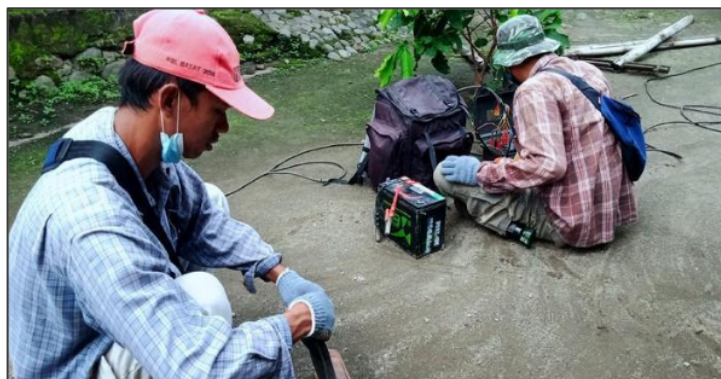
Gambar 3 Pengukuran geolistrik di komplek amblesan Desa Jungkare. (Foto oleh Detik.com saat melakukan peliputan)
