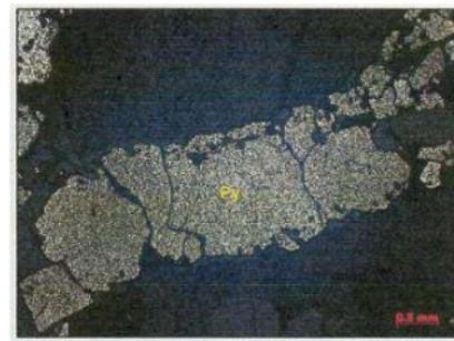
Gambar 15. Foto mikrograf mineral bijih pirit pada sayatan poles. Pengambilan conto TLB-53 pada titik LP-67 dengan litologi batuan dasit.
