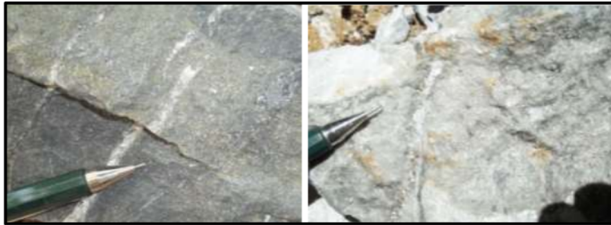
Gambar 5.0.1 Kenampakan granodiorit terpotong oleh urat halus silica-pirit-kalkopirit (foto kiri), dan kenampakan granodiorit yang mengalami argiliti dn oksidasi kuat. Lokasi bukit Gendrowo.
