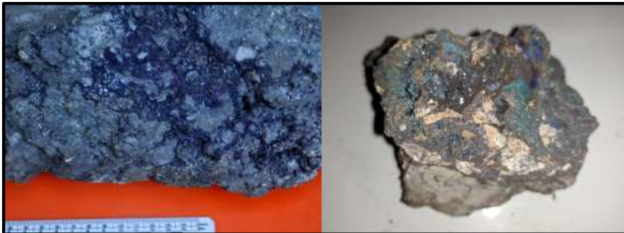
Gambar 6.0.24 Foto kiri mineral-mineral covellit telah mengganti hampir semua mineral sulfida pada matrik breksi hidrotermal magmatik. Sampel pit B West (foto Sutarto). Foto kanan Mineral Goetit, Malasit, Azurit Dan Mineral Sulfida Hitam Dalam Breksi Injeksi Hidrotermal Magmatik yang Terdapat Pada Sampel LP 18 Pit B West (Foto oleh : Dynasty Hadyan Saputro).
