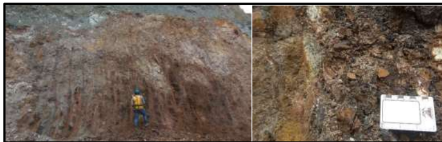
Gambar 6.0.22 Singkapan Breksi Injeksi Hidrotermal Magmatik dengan Fragmen Silika dan Matriks Sulfida Pada Lokasi Pengamatan 18 Pit B West yang Sudah Teralterasi Silika + Alunit ± Dickit. (Foto oleh : Dynasty Hadyan Saputro).
