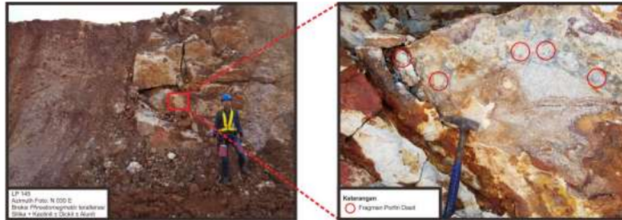
Gambar 6.0.14 Singkapan Breksi Freatomagmatik dengan Fragmen Porfiri Dasit Pada Lokasi Pengamatan 145 Pit C yang Sudah Teralterasi Silika + Kaolinit ± Dickit ± Alunit dan Terdapat Mineral Pirit Pada Matriks Batuan (Foto oleh Khafarel Laudza P).
