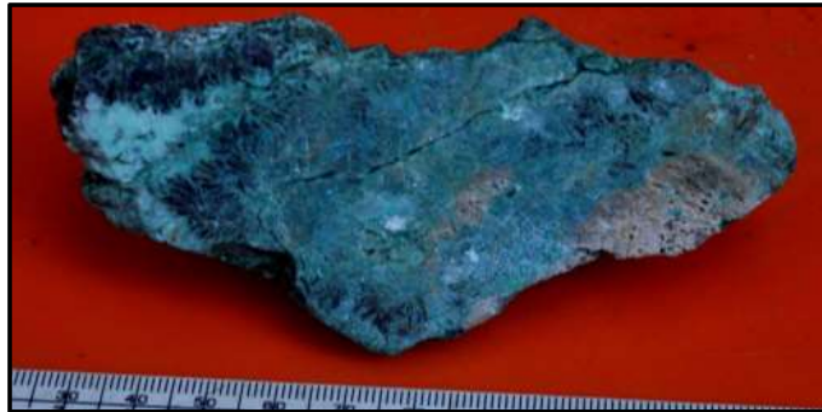
Gambar 0.17 Mineral Azurit, Malasit dan Kovelit Pada Breksi Freatomagmatik. Kovelit banyak tumbuh pada matrik breksi (Foto oleh Sutarto).
