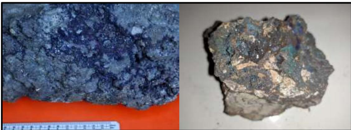
**Gambar 6.0.24** Foto kiri mineral-mineral covelit telah mengganti hampir semua mineral sulfida pada matrik breksi hidrotermal magmatik. Sampel pit B West (foto Sutarto). Foto kanan Mineral Goetit, Malasit, Azurit Dan Mineral Sulfida Hitam Dalam Breksi Injeksi Hidrotermal Magmatik yang Terdapat Pada Sampel LP 18 *Pit B West* (Foto oleh : Dynasty Hadyan Saputro).
