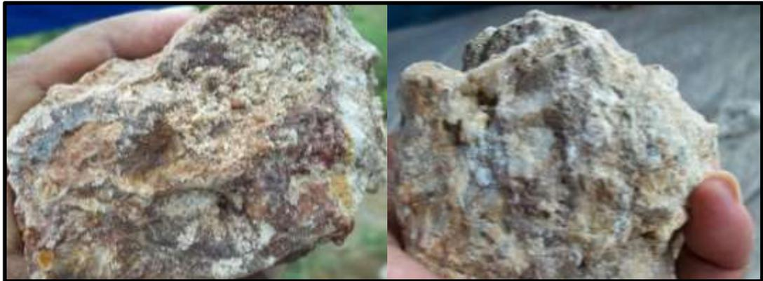
**Gambar 5.0.8** Kenampakan matrik breksi vulkanik (kedalaman 20 m) yang mengalami oksidasi kuat (foto kiri), dan kenampakan soil hasil prose oksidasi kuat membentuk endapan laterit . Lokasi bukit Lamongan (Foto oleh Sutarto).
