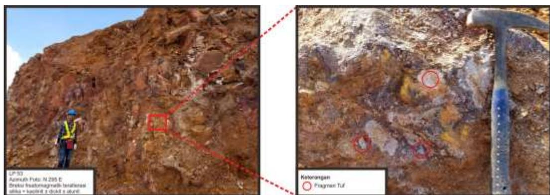
**Gambar 5.0.2** Singkapan Breksi Freatomagmatik dengan Fragmen Tuf Pada Lokasi Pengamatan 53 yang Sudah Teralterasi Silika + Kaolinit ± Dickit ± Alunit pada Zona Oksida (Foto Oleh Khafarel Laudza P)
