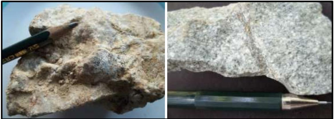
**Gambar 5.0.4** Foto kanan adalah breksi hidrotermal yang mengalami pelapukan, sedangkan gambar kanan granodiorite yang dipotong oleh urat kuarsa-sulfida. Lokasi bukit Gendruwo (Foto oleh Sutarto).
