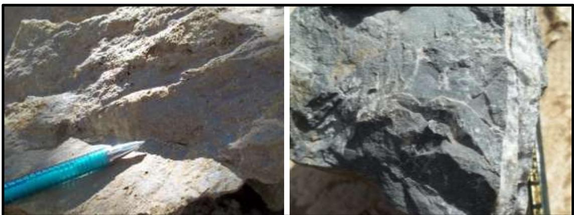
**Gambar 4.0.3** Kenampakan beberapa batun yang dijumpai di lokasi tambang rakyat Gunung Manis. Foto kiri kenampakan lapilli tuf dan foto kanan adalah basalt yang dipotong urat halus kuarsa (Foto oleh Sutarto)
