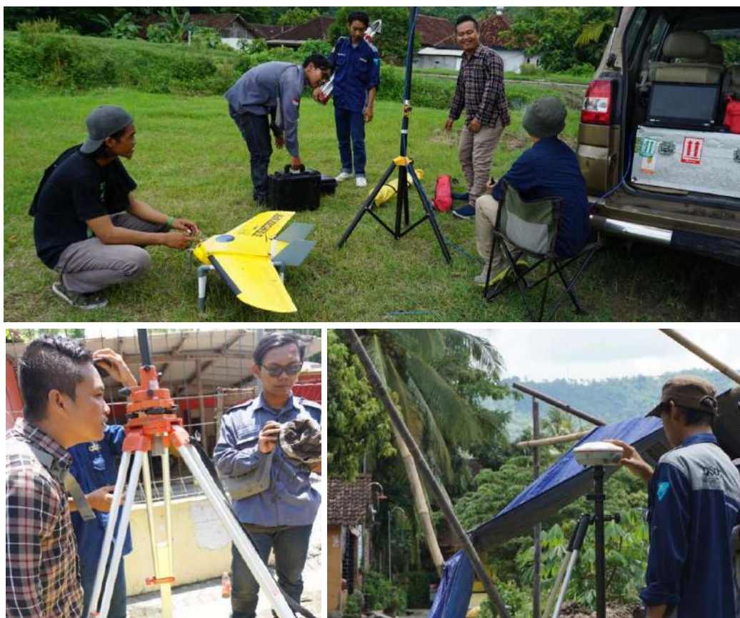
Gambar 1.3. Beberapa peralatan dan pelaksanaan kegiatan untuk pengambilan ortofoto udara menggunakan wahana UAV Potret 1300
