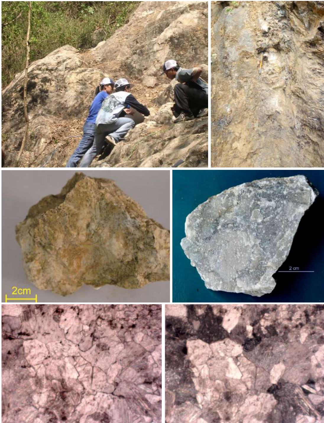
Gambar 4.7. Foto tas kenampakan singkapan marmer di Bukit Jokotuo. Foto tengah kenampakan contoh setangan marmer Joko Tuwo. Foto bawah kenampakan fotomikroskopik marmer yang disusun oleh mineral kalsit. selain kalsit, terdapat sedikit kandungan mineral kuarsa pada batuan ini.
