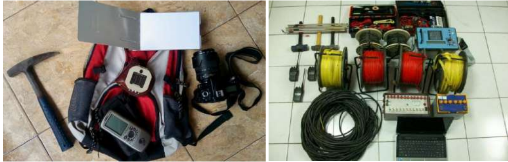
Gambar 1.2. Foto kiri: Beberapa perlengkapan yang diperlukan untuk kegiatan survey dan pemetaan geologi permukaan, diantaranya palu geologi, kompas geologi, GPS, kamera, clipboard). Foto kanan: satu set perlengkapan peralatan geolistrik type syscal.
