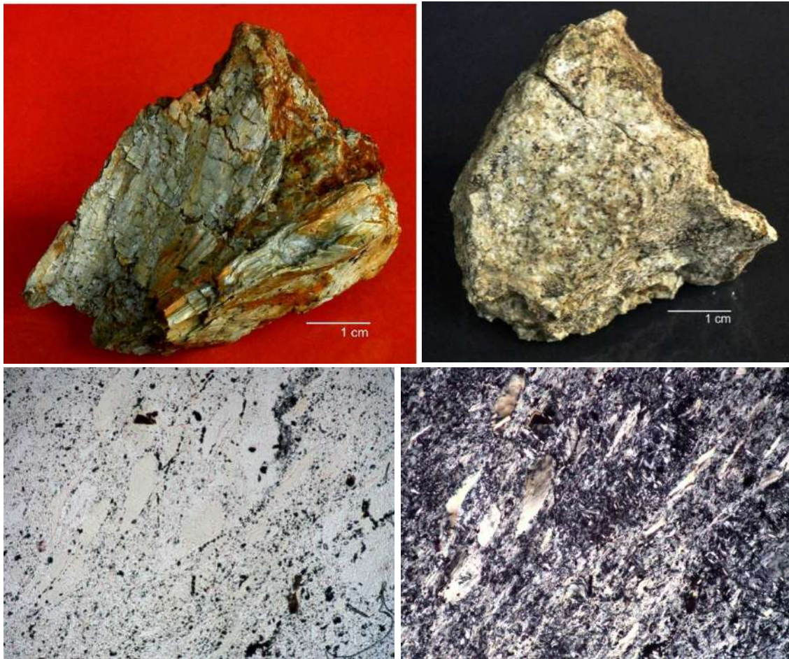
Gambar 4.6 Foto atas contoh setangan filit actinolit dan filit talk di G. Jabalkat, Jiwo Barat. Foto bawah kenampakan mikroskopis serpentinit. Liniasi mineral serpentin terlihat tersusun acak dengan tambahan mineral lempung berwarna putih.
