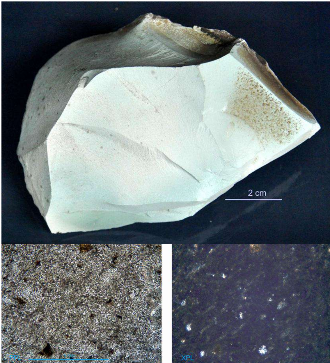
Gambar 5.10 Foto kenampakan conto setangan vitric tuff yang mengalami zeolitisasi (atas). Zeolitisasi adalah proses perubahan gelas menjadi mineral zeolit yang terjadi saat diagenesa. Warna semu kehijauan dalam foto conto setangan menandakan kehadiran mineral zeolit. Foto bawah kenampakan fotomikroskopik vitric tuff yang didominasi oleh gelas yang isotropik dan sebagian terubah menjadi zeolit.
