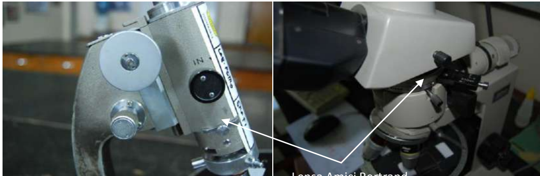
Gambar 1.4. Kenampakan lensa amici bertrand pada mikroskop polarisasi Olympus yang berbentuk bulat (kiri) dan pada mikroskop polarisasi Nikon yang berbentuk keping segi empat.
