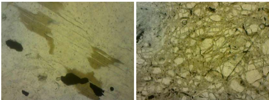
Gambar 3.4 Memperlihatkan Kenampakan fotomikroskopik belahan pada mineral plogopit (kiri) dan pecahan pada olivin (kanan) . Foto pada posisi nikol sejajar.
