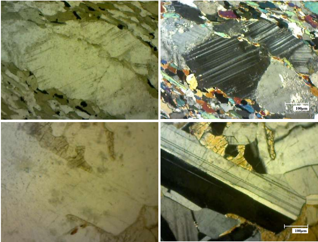
Gambar 9.3 Kenampakan plagioklas (albit) pada gneis (atas) dan plagioklas (labradorit) pada gabro (bawah). Semua fotomikroskopik sebelah kiri dalam posisi nikol sejajar ( plane polarized light ), sedangkan foto kanan posisi nikol silang ( crossed polarized light ).
