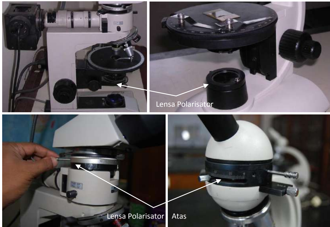
Gambar 1.6. Kenampakan Lensa Polarisator bawah dan Polarisator atas pada mikroskop Nikon (kiri) dan Motik (kanan).
