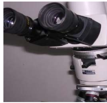
Gambar 1.2. Kenampakan lensa okuler pada mikroskop polarisasi Nikon.
