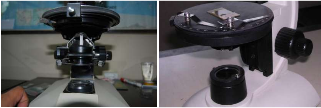
Gambar 1.8. Kenampakan Lensa Kondensor (kiri) dan kenampakan sekrup pengatur fokus pada mikroskop polarisasi Nikon (kanan).
