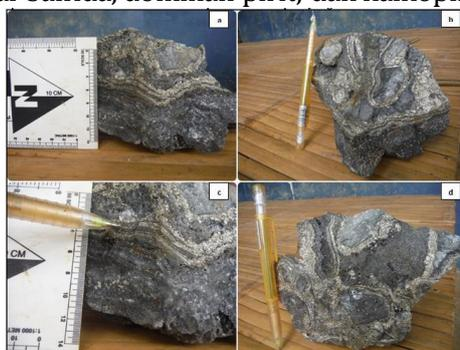
Gambar 9. (a,b). Kenampakan *Handspacimen* tekstur *crustiform-colloform* dan *cockade* pada urat L400-50, (c). Layering mineral sulfida pada tekstur *crustiform-colloform*, (d). Tekstur *cockade* yang dilingkupi layering mineral sulfida.
