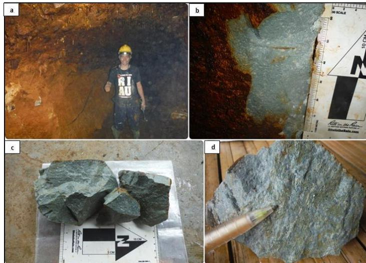
**Gambar 7. Kenampakan tipe alterasi propilitik. (a).Singkapan pada dinding terowongan, (b).Foto parameter pada bagian permukaan telah mengalami oksidasi, (c).Foto handspacimen, (d).Kenampakan mineral klorit, epidot, dan pirit disseminasi.**
