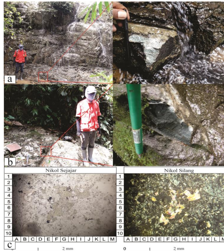
Gambar a. Kenampakan singkapan tipe alterasi kloritisasi pada litologi lava andesit LP 7, b. Kenampakan singkapan tipe alterasi kloritisasi pada litologi lava andesit LP 39, c. Sayatan tipis tipe alterasi kloritisasi LP 7 (klorit G6)
