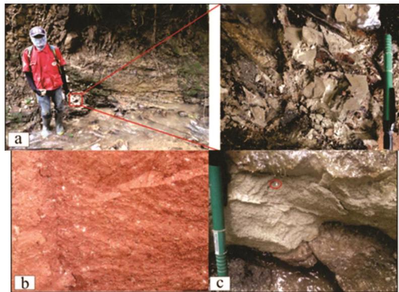
Gambar a. Kenampakan singkapan tuf tidak teralterasi LP 5; b. Kenampakan singkapan tuf teralterasi argilik LP 24; c. Mineral pirit pada tuf LP 15
