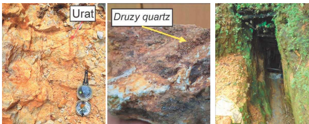
Gambar 7. Kenampakan kondisi batuan terubah, menunjukkan adanya urat-urat kuarsa saling memotong yang berada di LP 2 (kiri), tekstur druzy quartz yang teroksidasi (tengah), dan Lubang tambang yang dibuat oleh warga local (kanan).
