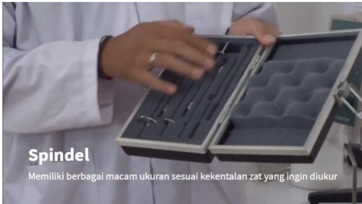
Gambar 3.3. Berbagai macam ukuran spindel
