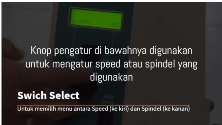
Gambar 3.6. Tombol switch select untuk memilih pengaturan speed atau spindel
