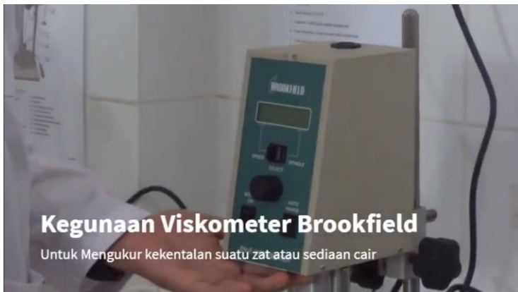
Gambar 3.2. Kegunaan Viskometer Brookfield
