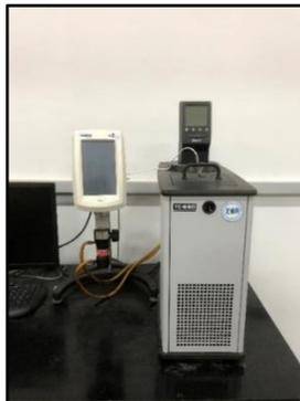
**Gambar 3.15. Rangkaian Alat Viskometer**
