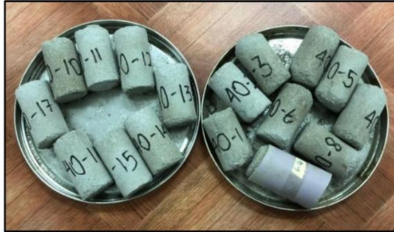
**Gambar 3.9. Sampel *Artificial Core* dengan Pasir Kwarsa Ukuran *Mesh 40***
