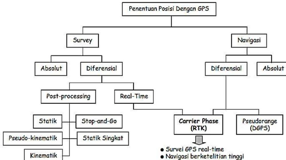
**Gambar 9.** Metode dan sistem penentuan posisi dengan GPS [Langley, 1998]
