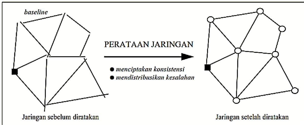
**Gambar 15.** Perataan jaring GNSS (SNI JKH, 2002)
