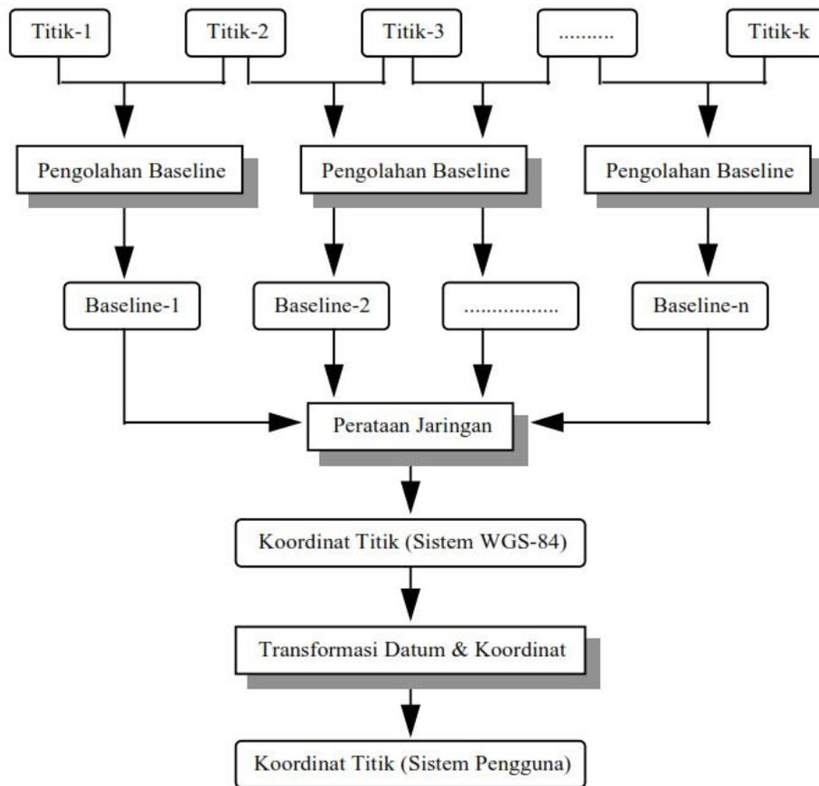
**Gambar 8.** Diagram alir perhitungan koordinat titik-titik jaringan GPS
