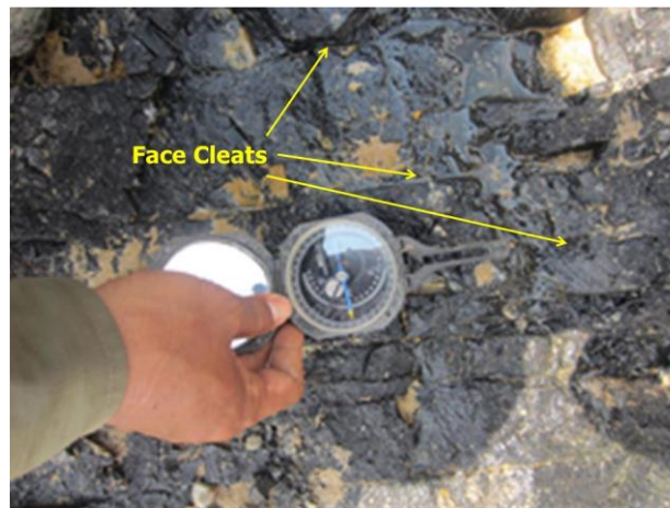
Gambar 3. Pengukuran Cleat pada Seam M-10 Formasi Warukin
