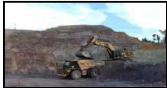
Gambar 3.2 Pola Pemuatan Bottom Loading
