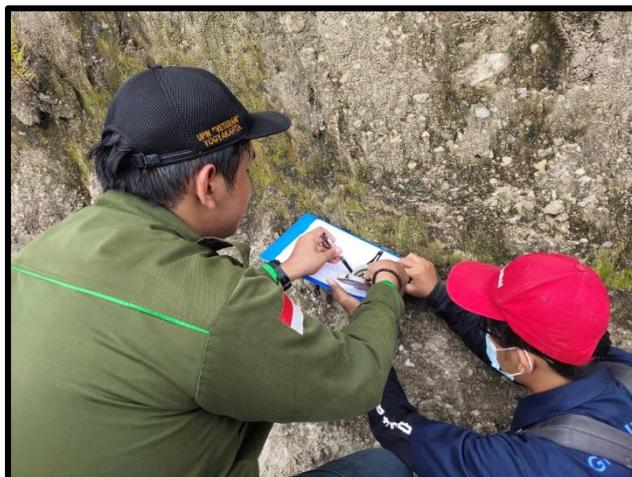
**Gambar 4.7** Pengukuran Kedudukan Batuan Menggunakan Kompas Geologi di LP 34
