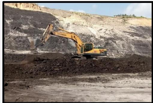
Gambar D.4 Pembongkaran Overburden
