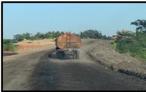
Gambar D.11 Penyiraman jalan Tambang
