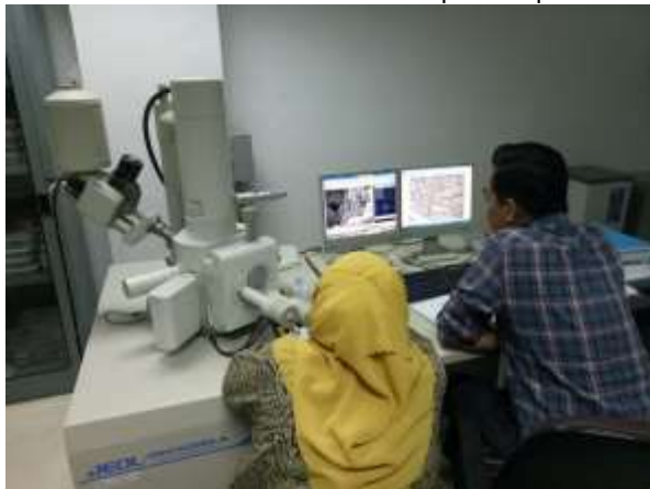
Gambar 5.10. Proses determinasi menggunakan SEM dan perangkat komputer komplit
