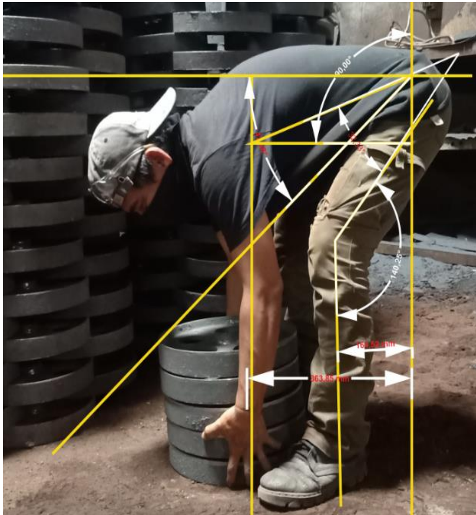
Gambar 4.2 Pengukuran dimensi pekerja 1 dalam pengangkatan pulley pada stasiun kerja pengecoran
