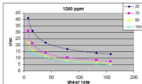
**Gambar 6.** Viskositas polimer HYBOMAX 4785 konsentrasi 1200 ppm
