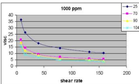
**Gambar 4.** Viskositas polimer HYBOMAX 4785 konsentrasi 1000 ppm
