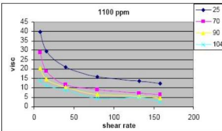
**Gambar 5.** Viskositas polimer HYBOMAX 4785 konsentrasi 1100 ppm
