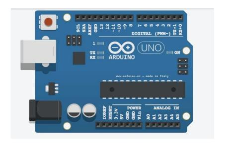
Pertama kita akan melihat semua bagian dari Arduino. Arduino pada dasarnya adalah komputer kecil yang dapat terhubung ke sirkuit listrik. The Arduino Uno ditenagai oleh chip Atmega 328P, itu adalah chip terbesar di papan (lihat catatan gambar pada gambar di atas). Chip ini mampu menjalankan program yang disimpan dalam memori (sangat terbatas).
