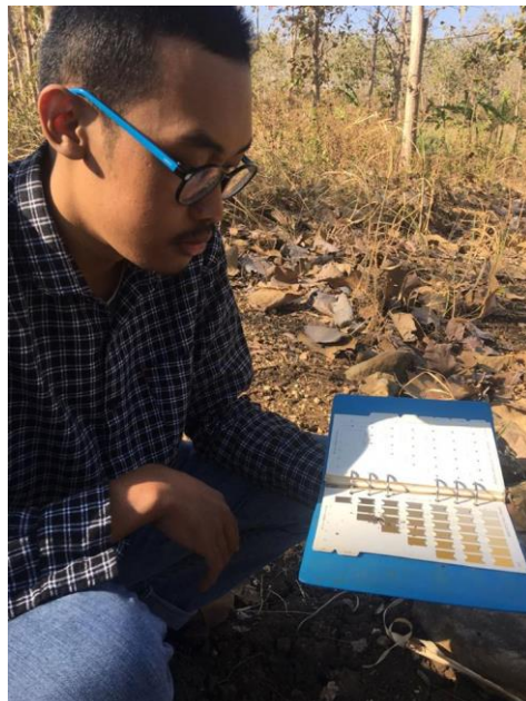
Gambar 3. Penulis membaca warna tanah menggunakan buku Soil Munsell Color Chart
