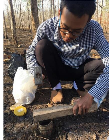
Gambar 2. Penulis mengambil sampel BV dan permeabilitas yang nantinya akan diuji di laboratorium
