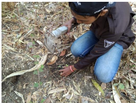
Gambar 3.2. Pengambilan Sampel Tanah Menggunakan Ring Sampler
