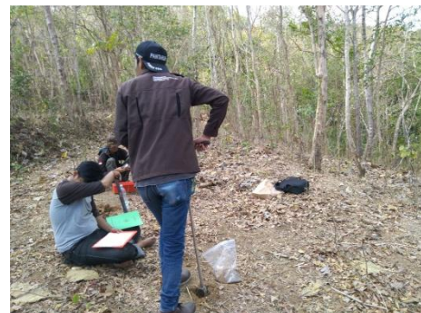
Gambar 3.3. Pengeboran Untuk Mengambil Sampel Tanah
