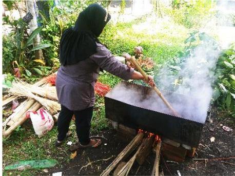
**Gambar 7.** Pengawetan bambu melalui perebusan
