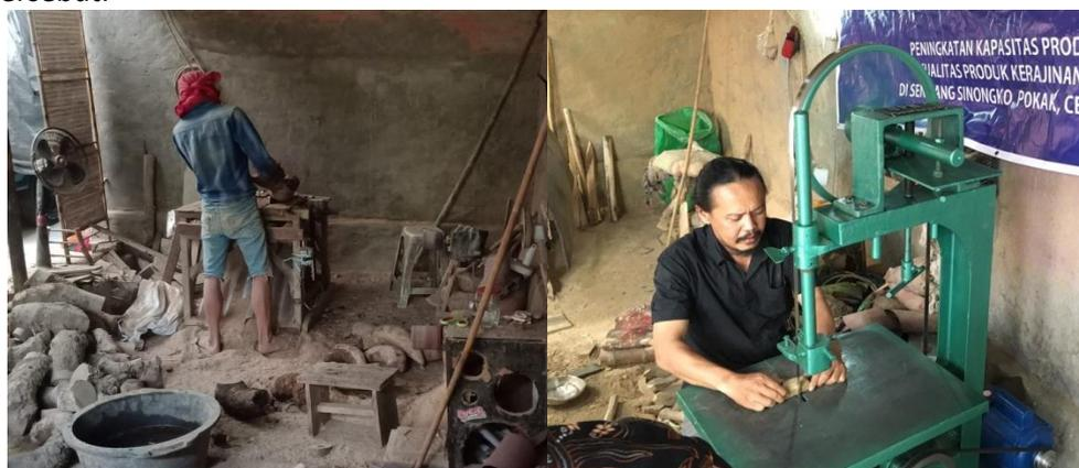
Gambar 5. Proses pemotongan manual dan menggunakan mesin
