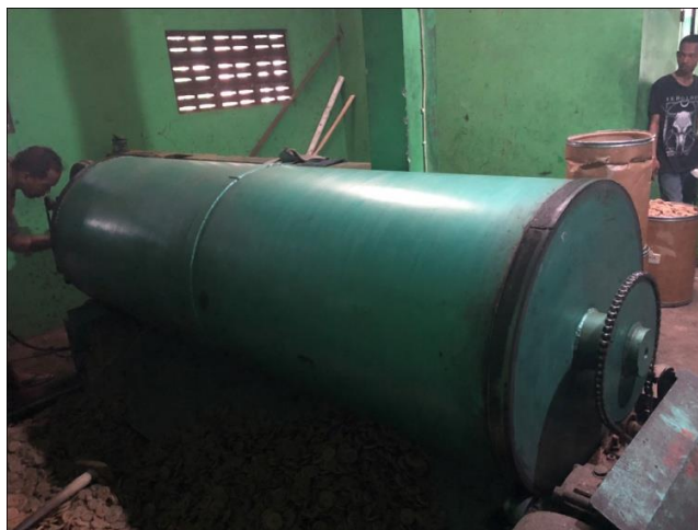
Gambar 3.3 Alat Pengering Kerupuk (sumber : UMKM Baruna Putra, 2020 )
