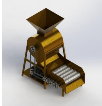
Gambar 2. Skema cara kerja dan rancangan mesin pengupas kulit salak
