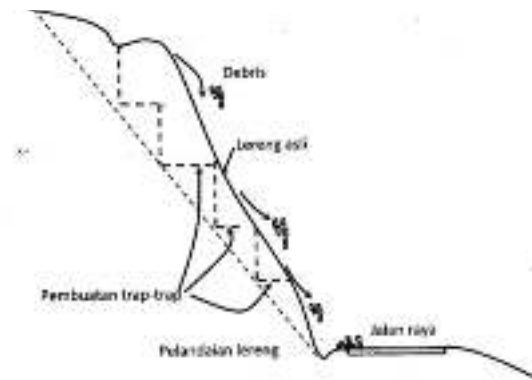
Gambar 3. Konsep trap/bangku untuk perbaikan geometri lereng (FHWA, 1988)
