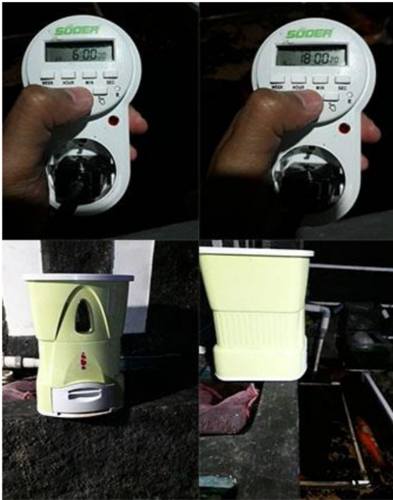
Gambar 5.2. Alat pemberi pakan ikan otomatis
