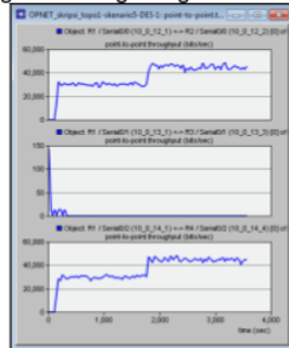
Gambar 8. Throughput link R1-R2 (atas), link R1-R3 (tengah), dan link R1-R4 (bawah) pada skenario 5
