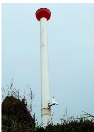
Gambar 4.3. Ombrometer buatan sederhana
