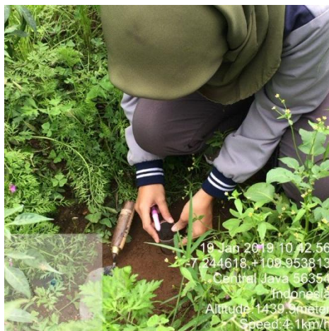
Pengambilan sampel tanah menggunakan ring sampel
