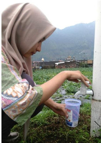
Pengukuran curah hujan menggunakan ombrometer buatan
