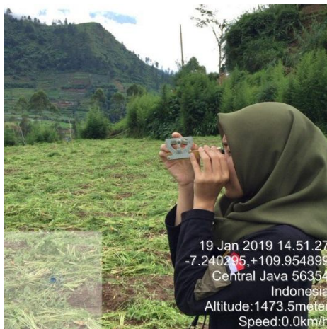
Pengukuran kemiringan lereng menggunakan abney level
