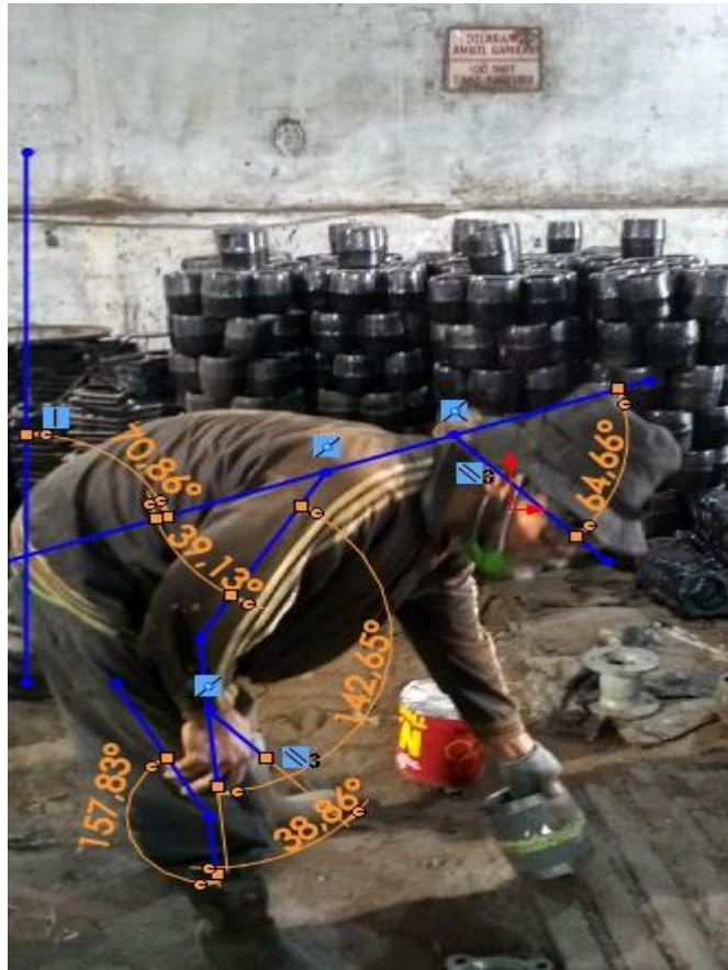
Gambar 4.8 Elemen kerja meletakkan giboult joint setelah selesai dihaluskan
