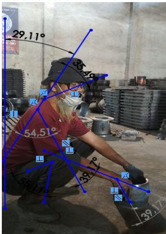
Gambar 4.25 Elemen kerja meletakkan giboult joint setelah selesai dihaluskan
