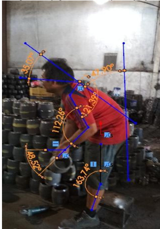
Gambar 4.7 Elemen kerja mengangkat giboult joint
