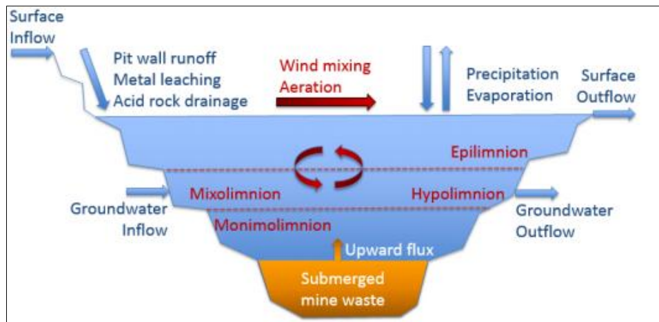
Gambar 3.1 Model konseptual pit lake untuk water balance , water column mixing , dan dinamika geokimia. (Vandenberg, dkk, 2015)
