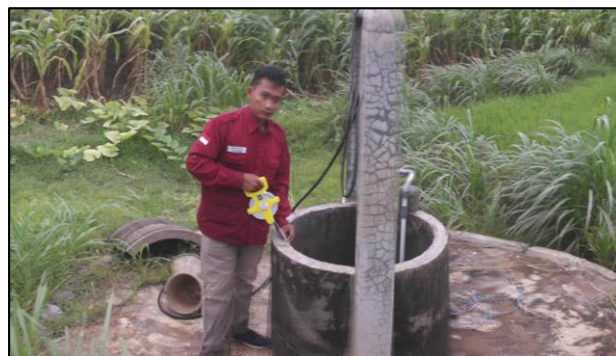
Gambar 3.6. Pengukuran Kedalaman Air Tanah (Kamera Menghadap Timur, Foto Penulis, Januari 2019)
