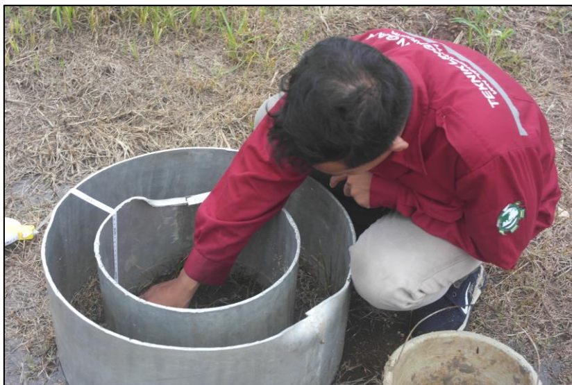
Gambar 3.7. Pengukuran Infiltrasi (Kamera Menghadap Timur, Foto Penulis, Januari 2019)
