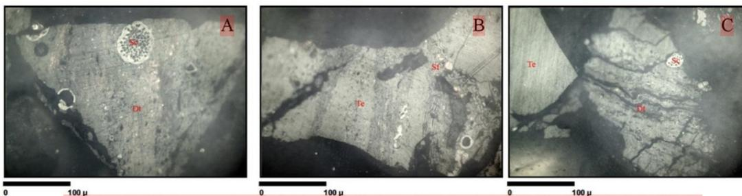
Gambar 3. (A) kenampakan reflektan semifusinite (Sf) dan telovitrinite (Te), (B) telovitrinite (Te), detrovitrinite (Dt) dan sclerotinite (Sc), (C) sclerotinite (Sc) dan detrovitrinite (Te)
