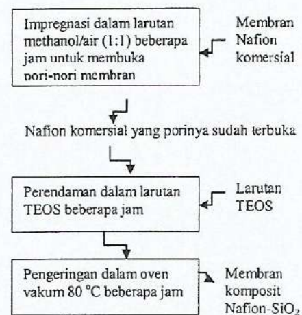
Gambar 1. Diagram alir sintesis membran komposit Nafion-SiO 2 metode impregnasi
