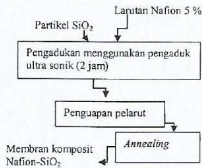
Gambar 2. Diagram alir sintesis membran komposit Nafion-SiO 2 metode dispersi
