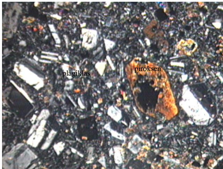
Foto 3. Sayatan petrografi diorit lokasi gunung Telu di mana diorit mempunyai terstruktur porfiritik dan mineral plagioklas sebagian berubah menjadi klorit.
