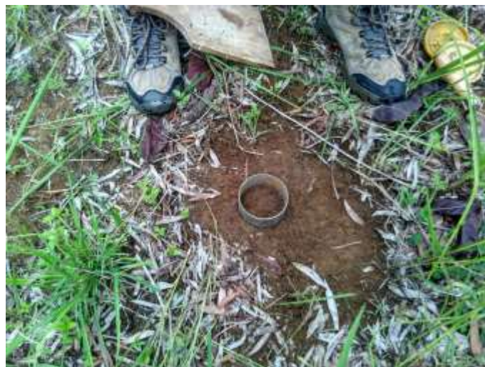
Lampiran 2 gambar proses pengambilan sampel tanah dengan menggunakan ring sampel
