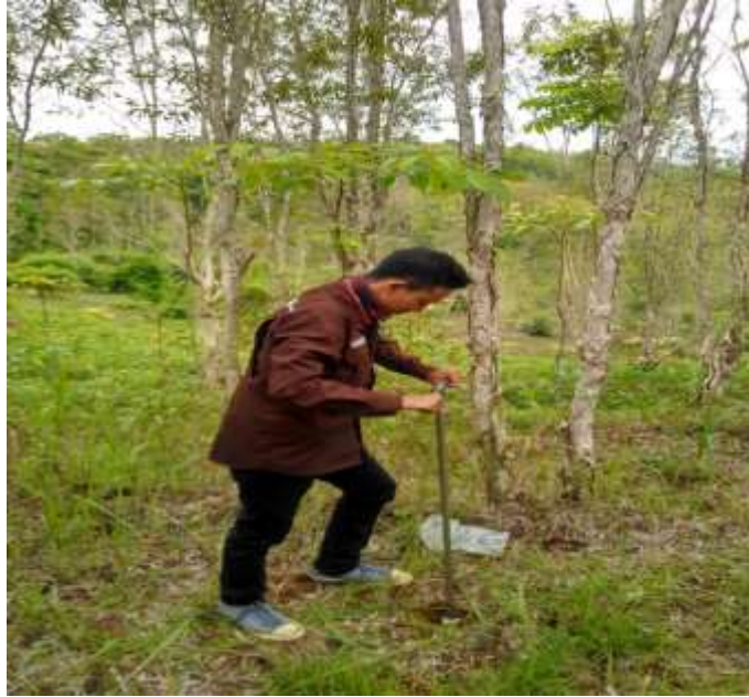
Gambar 6. Pengambilan sampel tanah dengan bor tanah.
