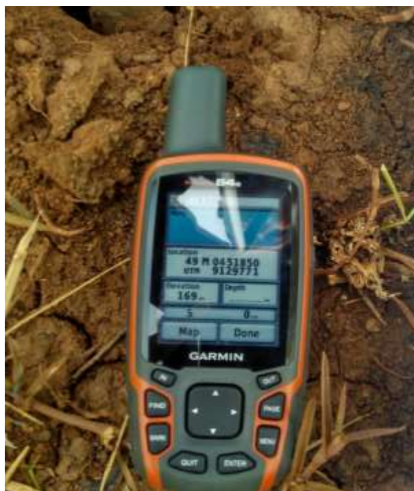
Lampiran 4 gambar penentuan titik koordinat pengambilan sampel dan pengukuran ketinggian tempat dengan GPS.
