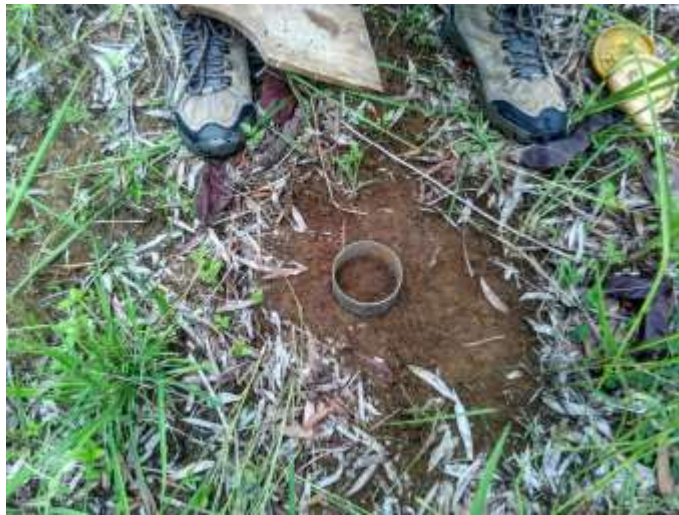
Gambar 7. Pengambilan sampel tanah dengan menggunakan ring sampel.
