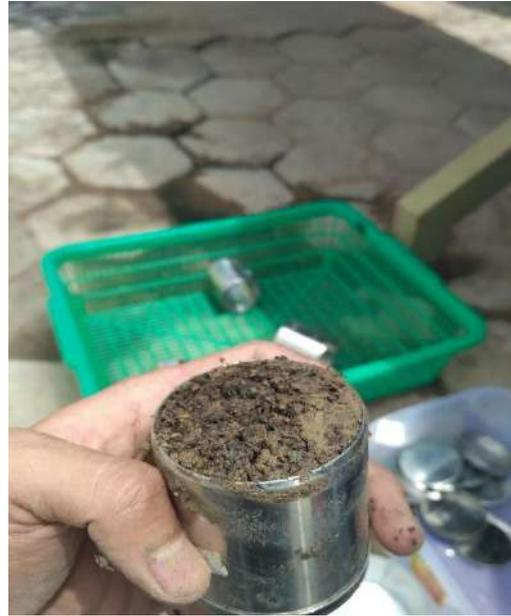
Gambar 12. Tanah pada ring sampel
