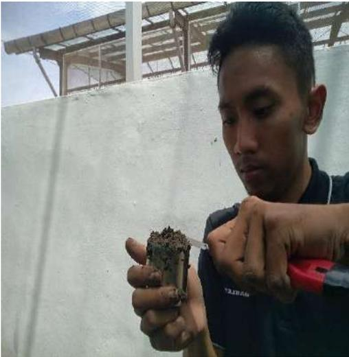
Gambar 18 Pemotongan sampel dengan cutter
