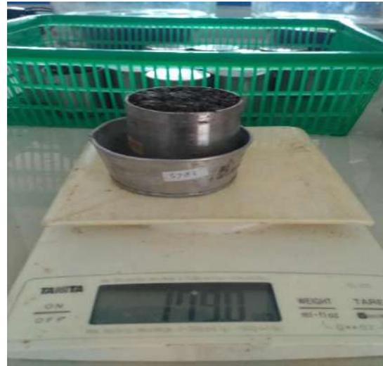
Gambar 19. Penimbangan sampel tanah
