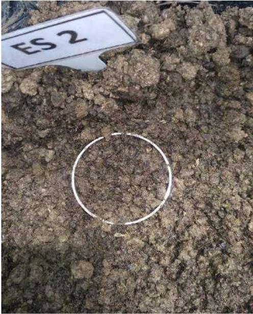
Gambar 11. Pengambilan sampel dengan Ring sampel
