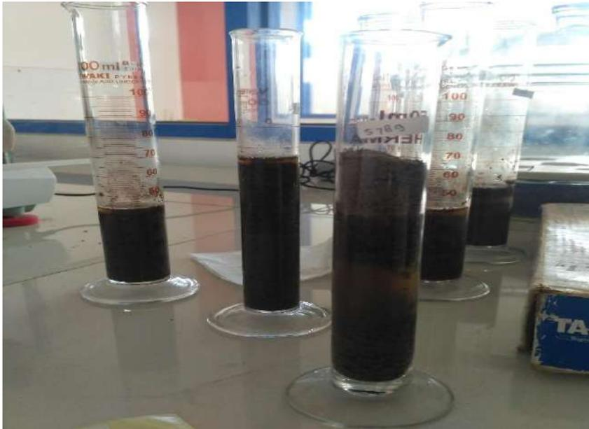
Gambar 15. Uji BJ tanah dengan gelas ukur
