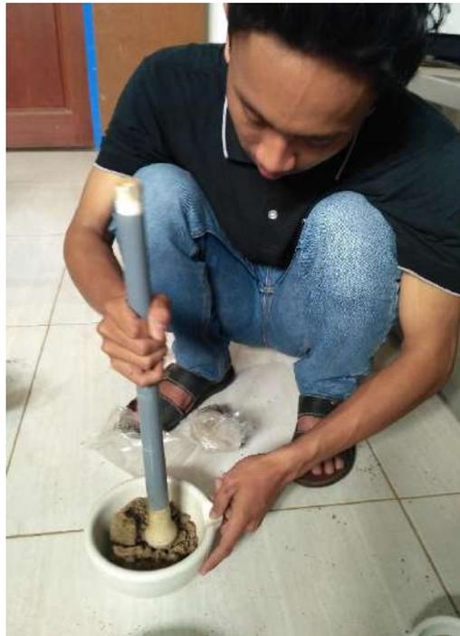
Gambar 13. Penumbukkan sampel tanah
