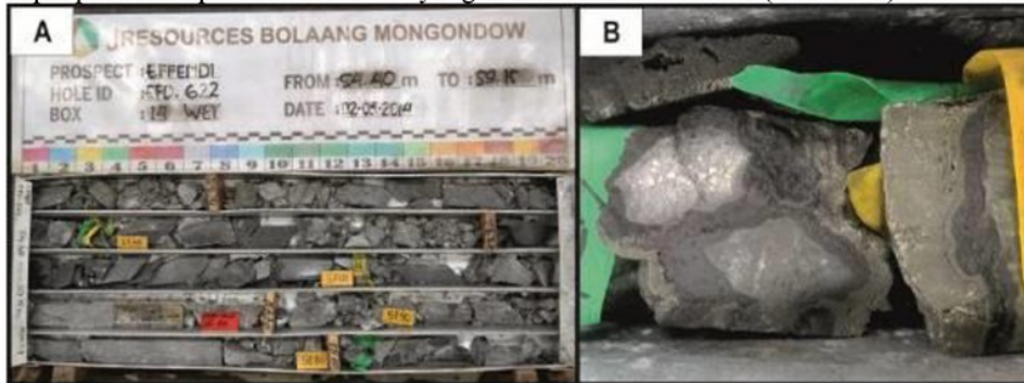
Gambar 5. Zona silika sulfida. a) Pada batuan inti EFD-622 kedalaman 55,4 - 59,15 m terlihat mineral pirit mengisi matrix batuan. b) Breksi hidrothermal dengan batuan induk tuf lapilli pada batuan inti EFD-622 kedalaman 65,2 - 65,4 m terlihat terdapat kehadiran mineral enargit, tenanit-tetrahidrit, pirit, dan kalkopirit.
